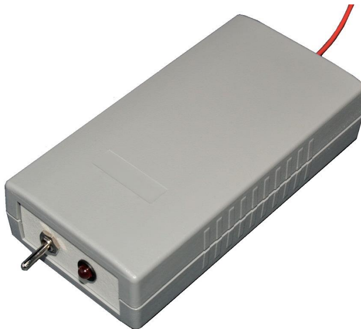
Slika 7. Izgled kratkovalnog ARG odašiljača s integriranim krugom
